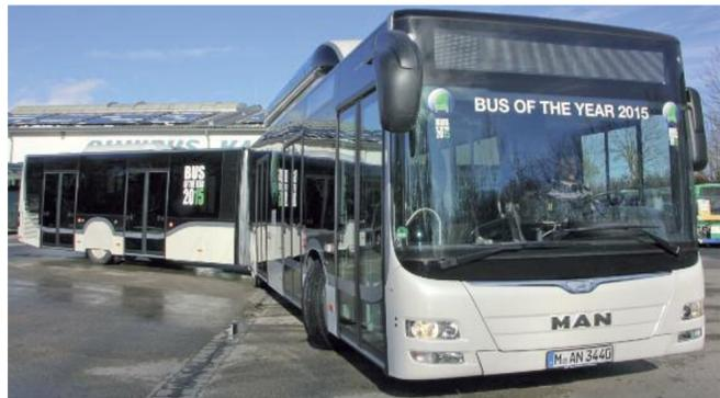
Unübersehbar sind die zehn Gasflaschen auf dem Dach des Vorderwagens untergebracht, was auch die Verkleidung nicht wirklich verbergen kann.
