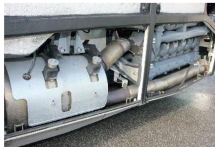
Kein Partikelfilter wie im Diesel, dafür ein schöner Drei-Wege-Kat (l.) sorgt für die Abgasreinigung des Euro-6-Triebwerks (r.).
